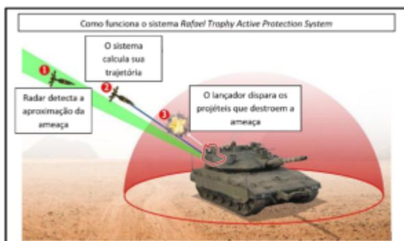
Figura 1 – Funcionamento do Sistema – Fonte Reddit, adaptado pelo autor
